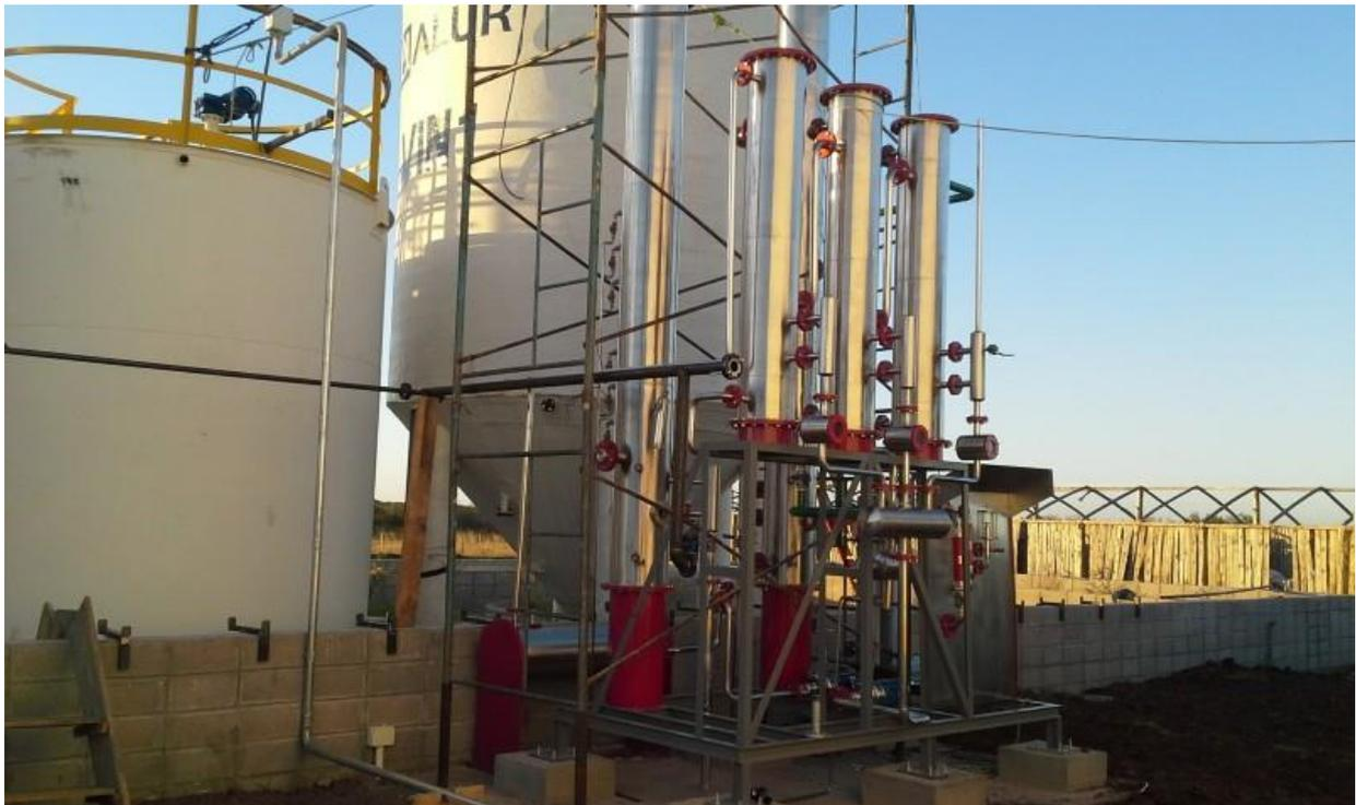
*Vista lateral modulo de destilación-rectificación, se aprecian los condensadores*
